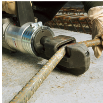
приспособление для гибки арматуры
