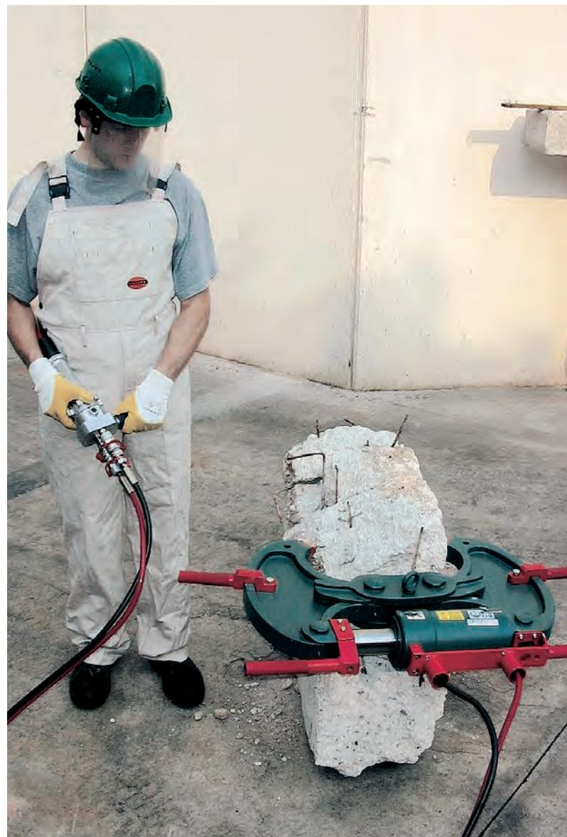
Предназначена для разрушения конструкций из бетона и преднапряженного железобетона, развивает большое усилие с точным приложением силы. Высокая эффективность разрушения таких конструкций, как лестницы, колонны, сваи, стены резервуаров, фундаменты, балки, железобетонные трубы, стены внутри помещений и т.п. Управление с удаленного пульта на расстоянии до 3-х метров. Максимальная толщина разрушающей железобетонной конструкции 400 мм (при ширине зева 300 мм), максимальная ширина зева 430 мм.
