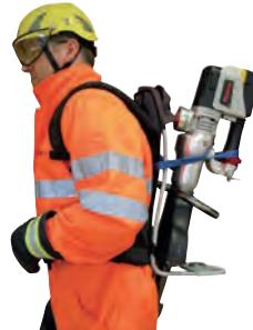
Снаряжение для переноски гидроинструмента на спине с верхней ручкой
